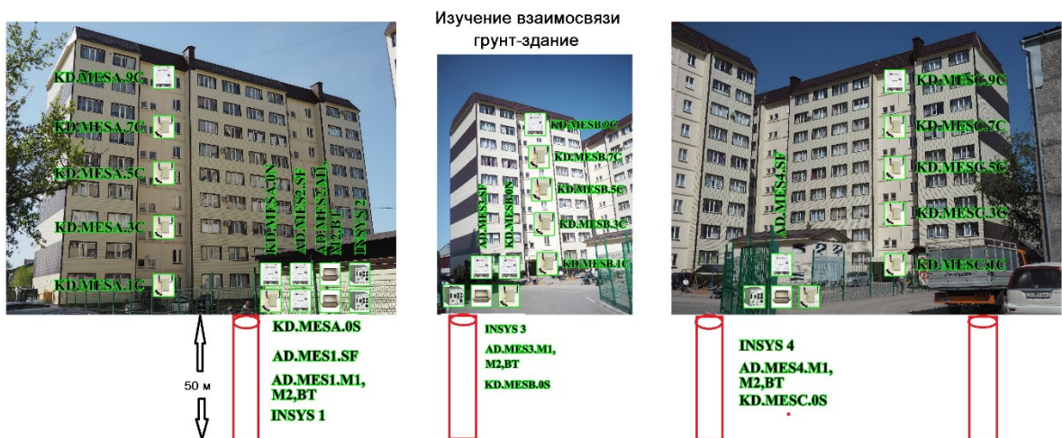
Рис 1.4.3. Схема установки сети акселерометров в скважинах (красные цилиндры) и зданиях (зеленые).
